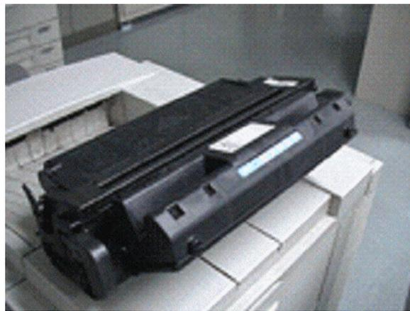
図1. レーザープリンタ用プロセスカートリッジ
