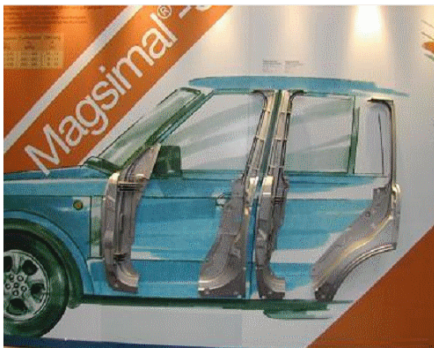
図3 車体用のアルミダイカスト部品
