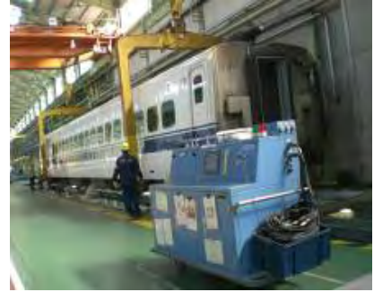
新幹線電車の車体上げ状況
