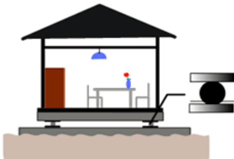
写真-2.免震工法の建築物
