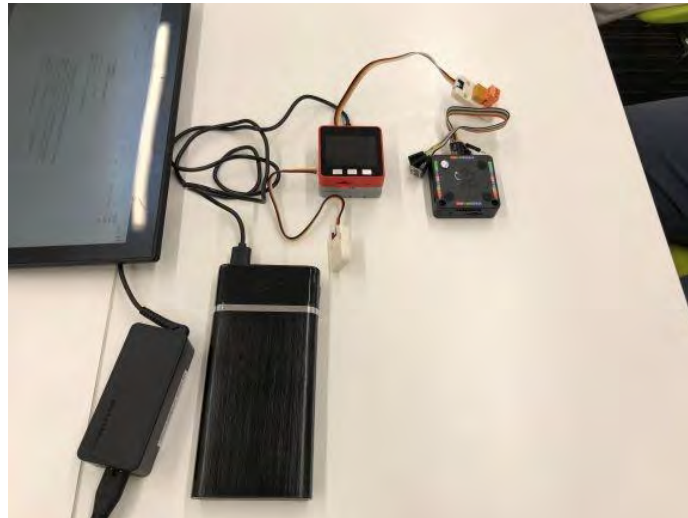
写真 「M5Stack」を用いた自動水撒きシステム
